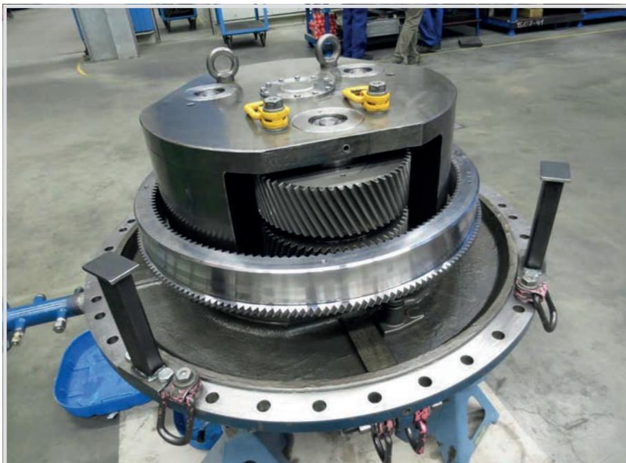
Bild 2. Teilmontiertes Stoeckicht-Planetengetriebe.
