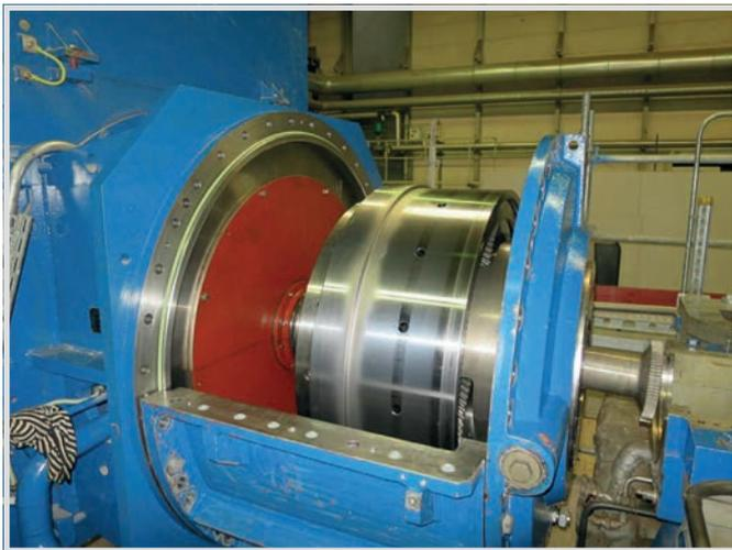
Bild 5. Einbau des Getriebes nach der Instandsetzung in die Anlage, Generatorseite.
