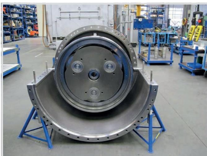
Bild 3. Instand gesetztes Planetengetriebe mit neuen Teilen.
