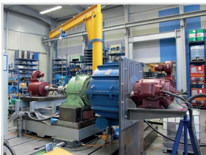
Bild 4. Probelauf des instand gesetzten Getriebes.
