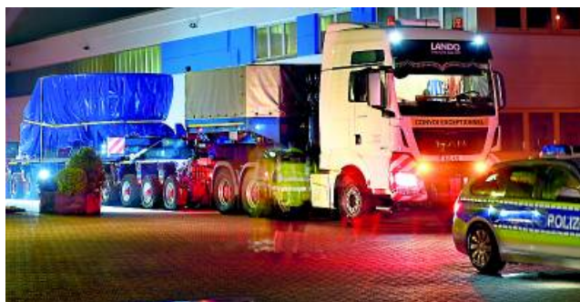
Mit einem 28 Meter langen Tieflader wird das Getriebe am Donnerstagabend auf den Heimweg gebracht.
