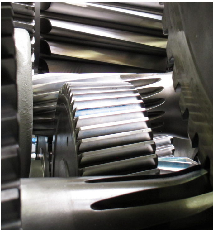
Ein Einblick in das schrägverzahnte Getriebe einer Schnitzelpresse (Doppelspindelpresse)
